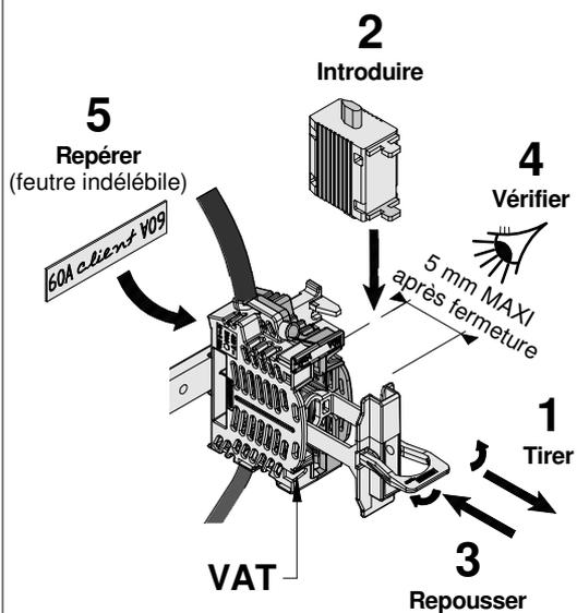
Ne pas mettre d'élément fusible ou neutre si le départ client n'est pas connecté.
